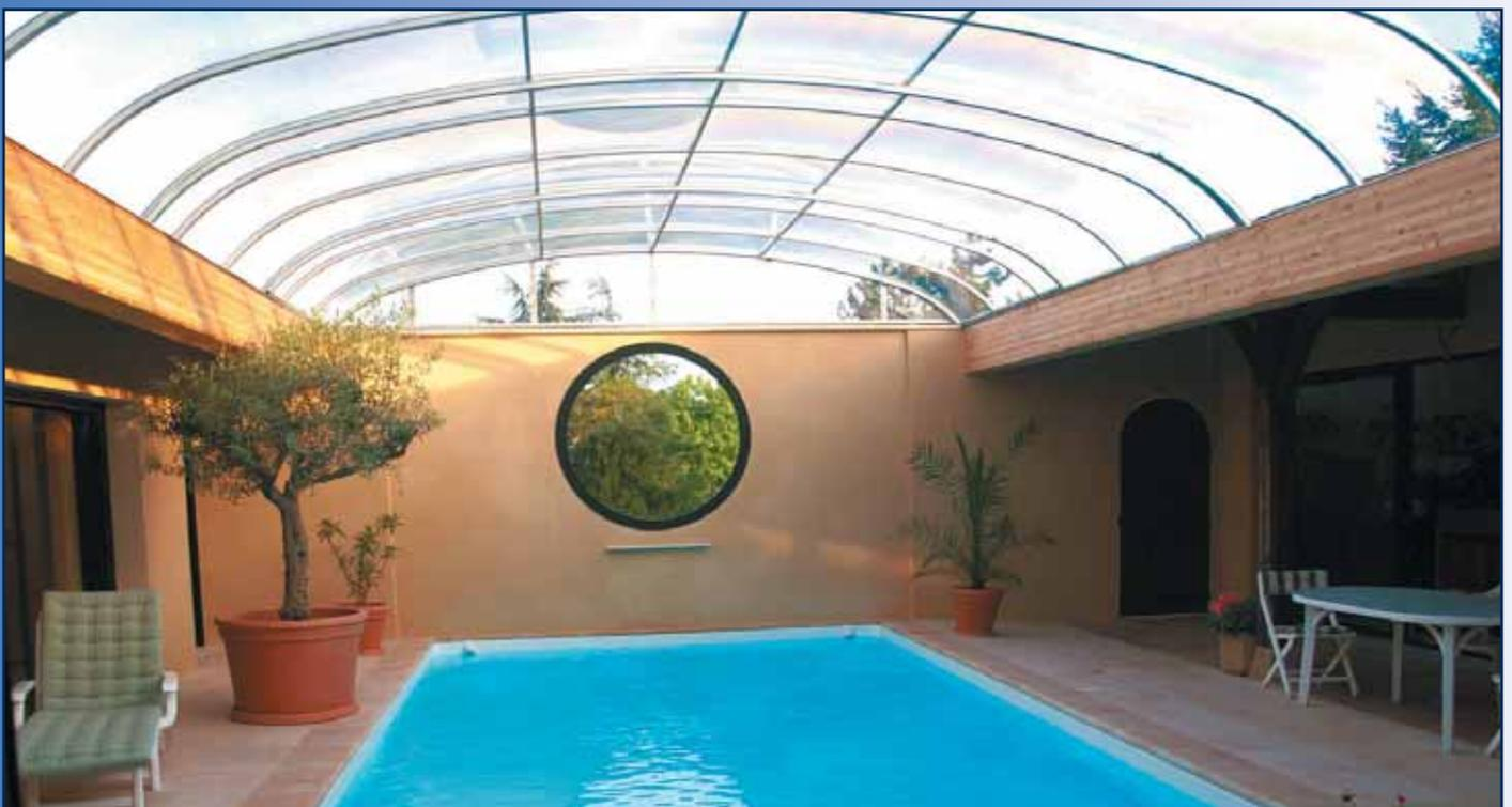
Bogenprofile eloxiert, Dachfläche aus 4 mm Kunststoffglas (Polycarbonat)
