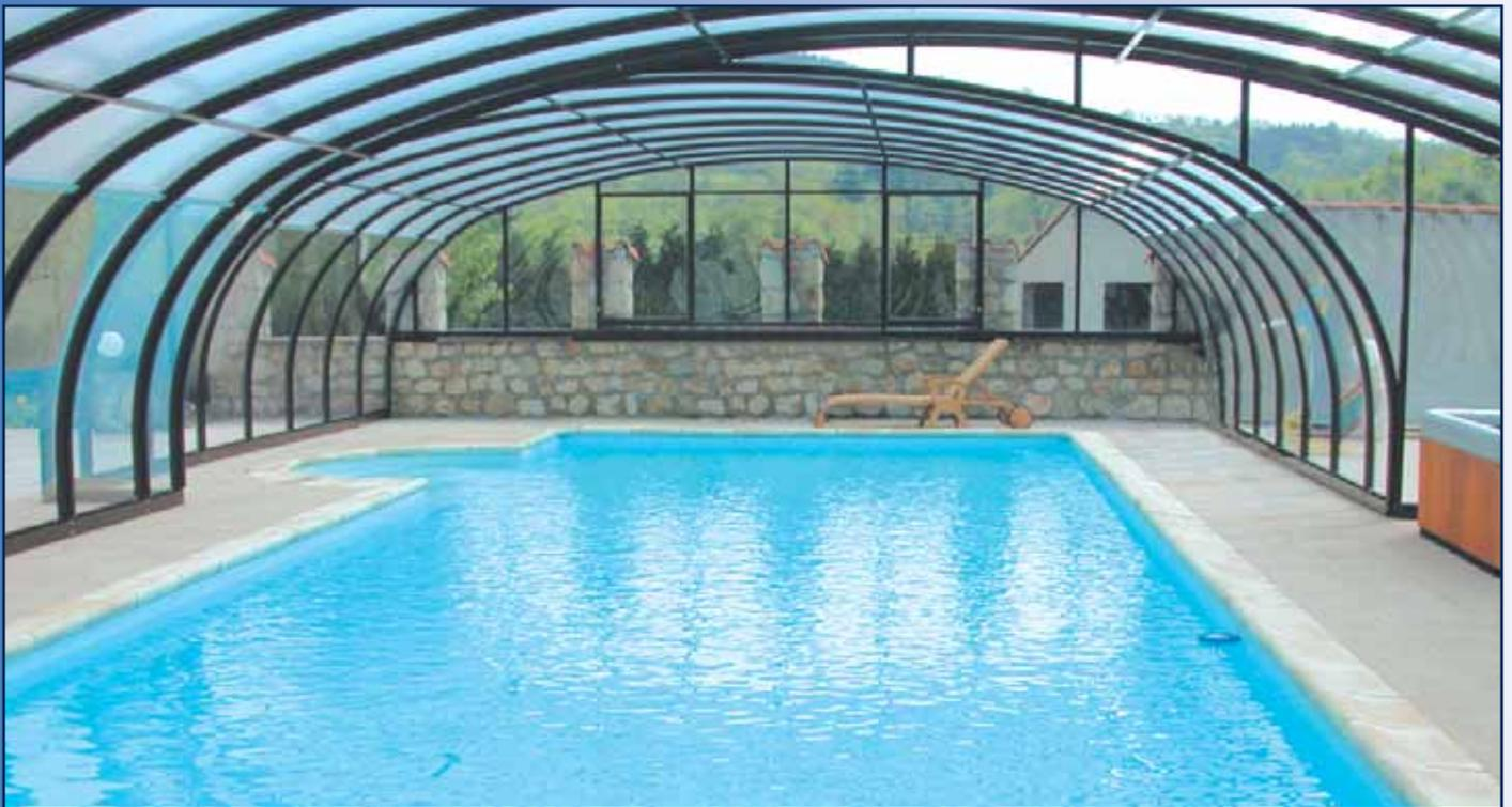
Bogenprofile in RAL 8014, Dachfläche aus 8 mm Doppelstegplatten, Stirnwände und Seitenwände aus 4mm Kunststoffglas
