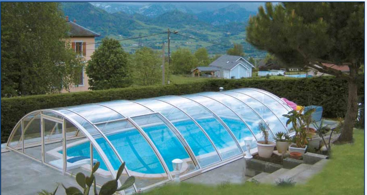
Bogenprofile weiß, Dachfläche und Stirnwände aus 4 mm Kunststoffglas, seitliche Schiebetüre
