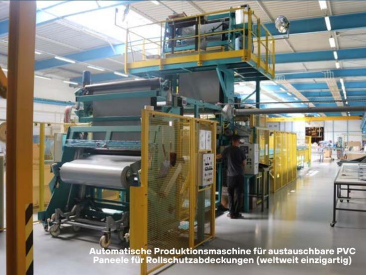
Automatische Produktionsmaschine für austauschbare PVC Paneele für Rollschutzabdeckungen (weltweit einzigartig)
