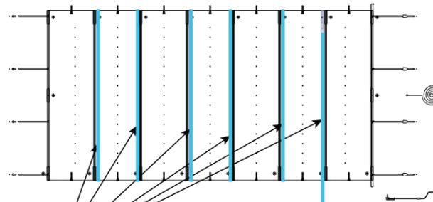
Platzieren Sie die Profile nebeneinander, um die Festigkeit der Abdeckung zu erhöhen und einen guten Abfluss des Regenwassers zu ermöglichen.
