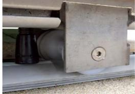
Bremse mit Gummibacke und Führungsr
