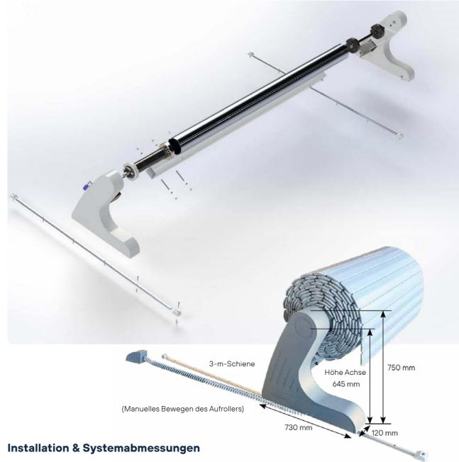
Aussenmass der Aufrollvorrichtung = Beckeninnenbreite + Randsteinbreite\* + 377mm
